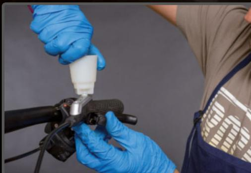
**PASO 2** > Enrosca el embudo a mano sin apretar demasiado, la rosca es de plástico y puede dañarse.
