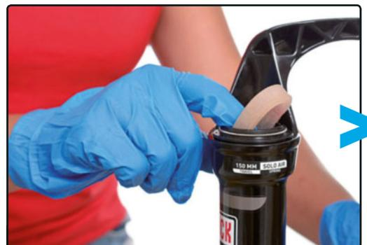
**PASO 9>** A continuación, coloca las esponjillas bien lubricadas en el interior.
