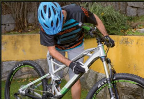
**PASO 8** > Hay que secar adecuadamente la bici; con un trapo seca todos los componentes y el cuadro y por último seca y lubrica la cadena para evitar oxidación.
