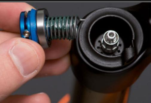
**PASO 7>** Alinea el tornillo con la entrada de la funda y encaja el muelle "donde pida".
