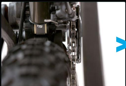
**PASO 8** ➤ Comprueba que queden 2 mm entre la cadena y el desviador.
