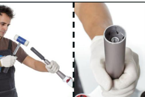
**PASO 7>** Procura que la araña quede unos 10 mm por debajo el borde, y con las "patas" hacia arriba, lo que la impide ser extraída en ese sentido.
