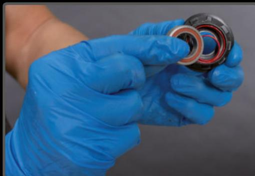
**PASO 10 >** El buje trasero lleva 4 rodamientos: dos en el buje y otros dos en el núcleo.
