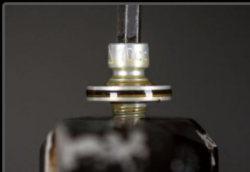
**PASO 2** > Antes de quitar los tornillos aflójalos y déjalos con un par de hilos de rosca dentro.
