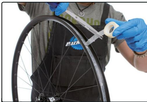
**PASO 2>** Tras darle una vuelta completa a la cinta la cortamos pasados 5 cm el agujero de la válvula de la llanta.
