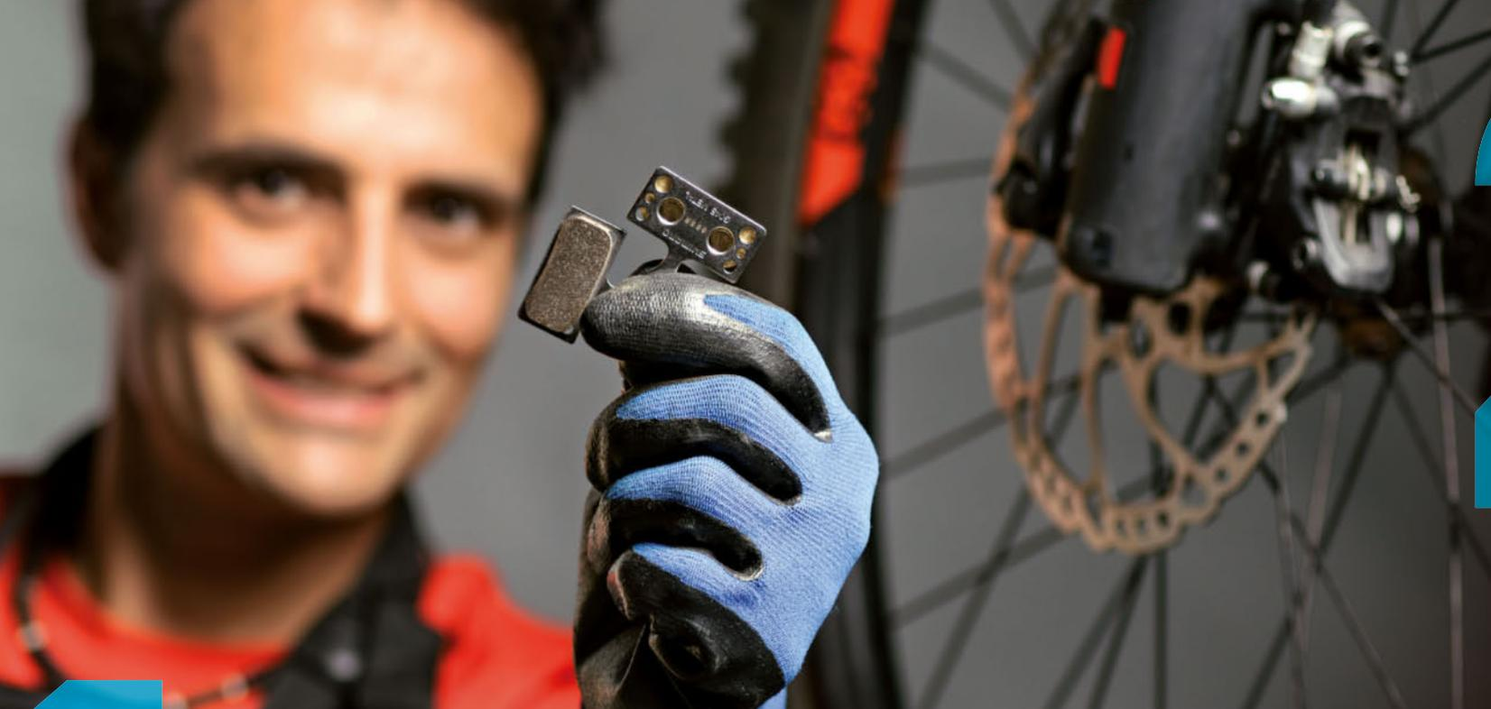
**SUSTITUCIÓN DE PASTILLAS EN FRENOS DE DISCO SHIMANO**
