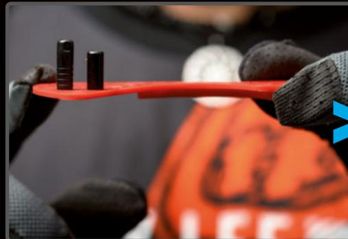
**PASO 3>** Utiliza siempre topes de aluminio. Los de plástico sufren compresiones que afectan al ajuste.
