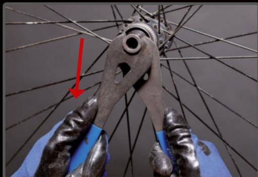
**PASO 4>** Sentido de giro normal (a izquierdas) para aflojar la tuerca. Mantén el cono sujeto.
