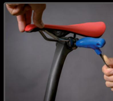
**PASO 12>** Reaprieta firmemente la fijación para avanzar el sillín, sin sobrepasar el par.
