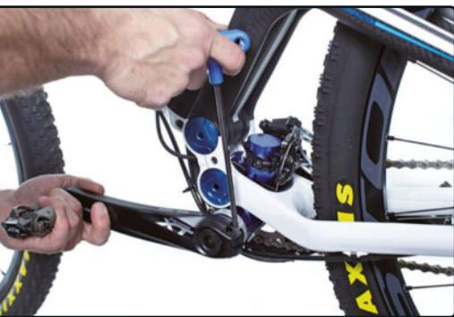
**PASO 1>** Aflojamos los dos tornillos que sujetan la biela izquierda.
