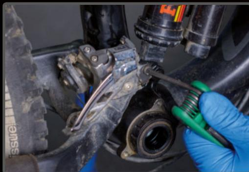
**PASO 4>** Si tu bici tiene un soporte del desviador desmontable, también puedes eliminarlo.
