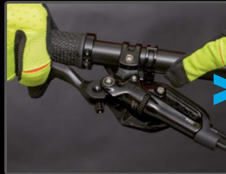
**PASO 6>** Algunos frenos ofrecen capacidad de regulación de tensado, como estos Guide.
