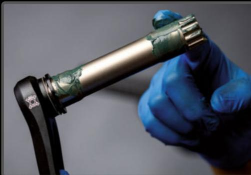
**PASO 11>** Engrasar las partes en contacto entre eje, rodamientos y encaje de la biela reduce la aparición de crujidos.
