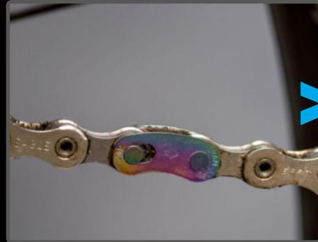
**PASO 6>** El eslabón desmontable, bien cerrado y con la flecha en el sentido del pedaleo.
