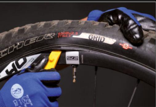
**PASO 1>** Ojo con el desmontable, no vayas a dañar el labio del flanco.
