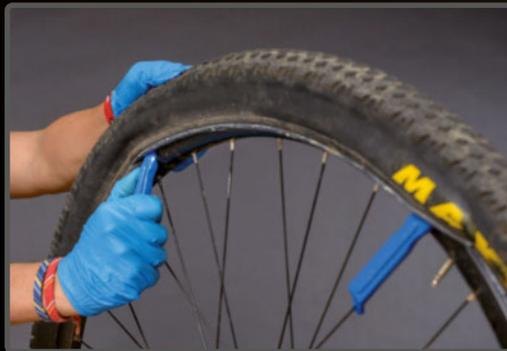
**PASO 2>** Algunos desmontables se pueden fijar a un radio, lo que facilita enormemente el proceso de extracción.
