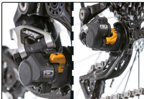
**PASO 8>** En la foto de la izquierda (on) el cambio está bloqueado; en la derecha (off) el cambio queda liberado.
