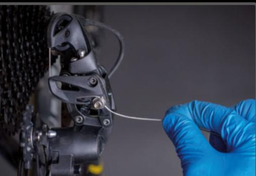
**PASO 7>** Observa el recorrido del cable en SRAM. Es fundamental hacerlo así.
