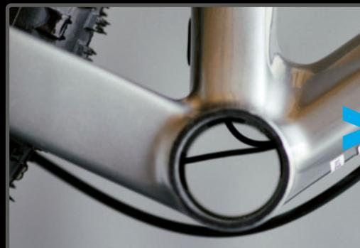
**PASO 9>** "Recoge" el exceso de cable y el conector de empalme en el interior del tubo diagonal.
