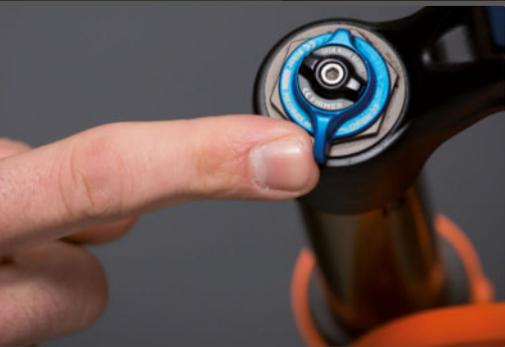
**PASO 1>** Empezamos poniendo el mando de ajuste de compresión en "abierto".
