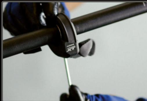
**PASO 2>** No te pases con el apriete. Entre 5 y 7 Nm es suficiente para que el mando FireBolt no se mueva al pulsar.
