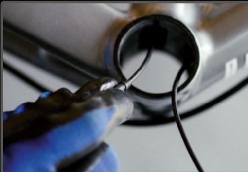
**PASO 5>** Todos los cables deben llegar hasta la caja del pedalier para poder hacer una conexión correcta.
