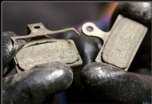
**PASO 4** > Evalúa el desgaste: si las pastillas tienen menos de 1 mm de grosor, hay que cambiar.
