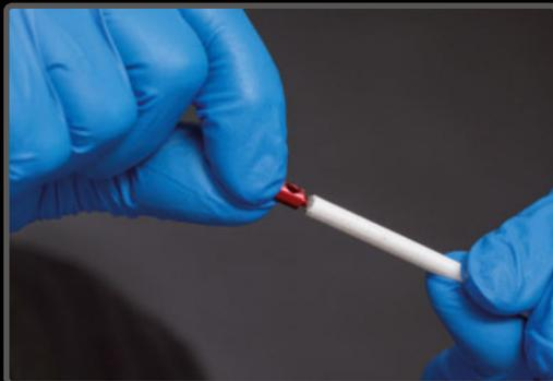
**PASO 4>** Rosca el terminal hasta el fondo. Si está "duro" introduce una palanca en el orificio.
