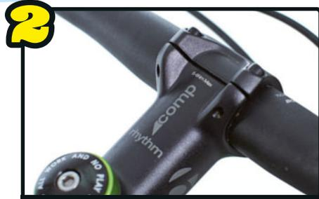
**2** En la potencia suele venir indicado el par recomendado, tanto en la fijación del manillar como en la de la horquilla. Pon especial atención con los componentes de carbono.
