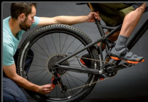
**PASO 8>** En dobles suspensiones, la posición del cambio respecto al casete cambia cuando nos montamos.
