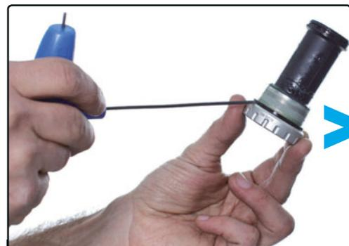
**PASO 6>** Al extraer el eje de pedalier fíjate en las arandelas que monta a cada lado.
