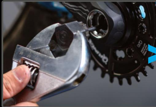
**PASO 7 >** Apretamos la biela derecha firmemente. Si hay mucha fricción necesitamos desmontar una arandela.
