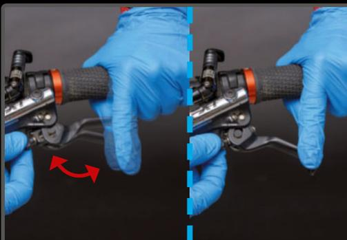
**PASO 11>** Bien a mano, o bien con una llave Allen de 2 mm, todos los frenos permiten ajustar el alcance, para alejar o aproximar la maneta de freno del manillar.
