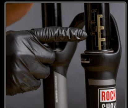
**PASO 12>** Los Sag Gradients de RockShox facilitan alcanzar el ajuste de sag adecuado.
