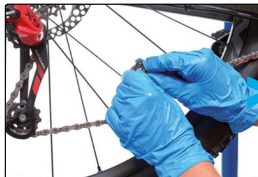
**PASO 9** > Ajusta correctamente el eslabón de montaje, encajando los pasadores con la placa contraria.
