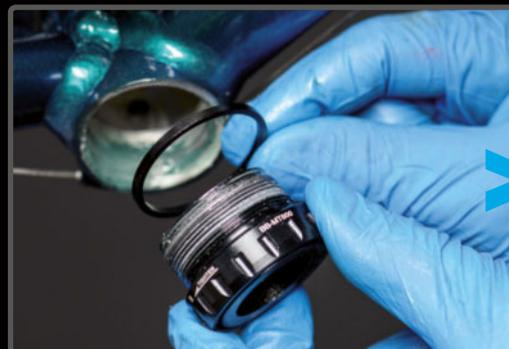
**PASO 9>** Es fundamental colocar las arandelas correctas, según las instrucciones de montaje.
