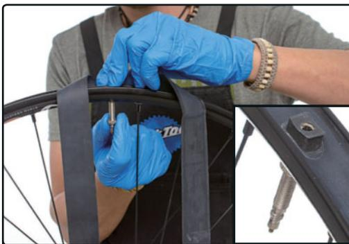
**PASO 5** ➤ Roscamos la válvula a la llanta; asegúrate de colocar la válvula correctamente y de roscaarla bien.
