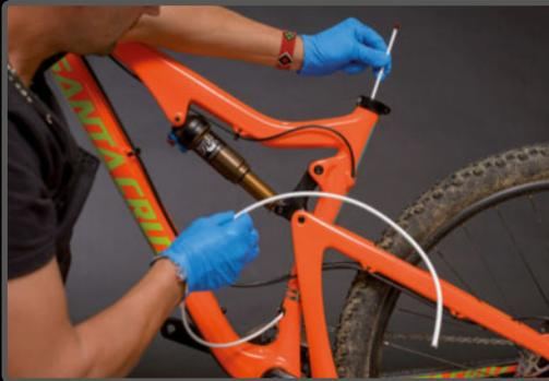
**PASO 5>** En algunos cuadros el latiguillo entra en la dirección, guiándolo a través del pedalier hacia el tubo vertical.
