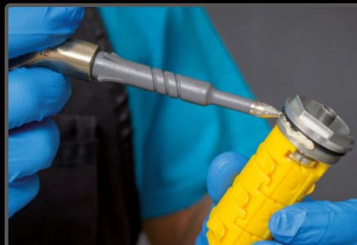
**PASO 8>** Un poco de grasa suaviza las roscas, y mantiene lubricada la junta tórica, evitando que se reseque.
