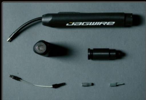
**PASO 4>** La herramienta Jagwire tiene adaptadores para cables, fundas, latiguillos y e-Tube.
