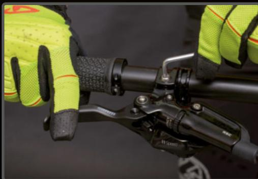
**PASO 4>** Fija la maneta de freno en su posición final, y comprueba que la posición es correcta.
