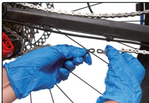
**PASO 8** > Coloca el eslabón de montaje. Recuerda introducir un pasador por cada lado de la cadena.
