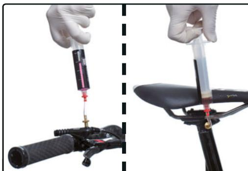
**PASO 8>** Es muy importante que mantengas las jeringas en posición vertical para evitar introducir aire dentro del circuito. Igualmente, no las presiones hasta el fondo.
