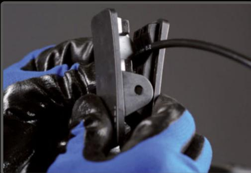
**PASO 4** > Utiliza siempre que puedas una guillotina. El corte tiene que ser recto, a 90°.
