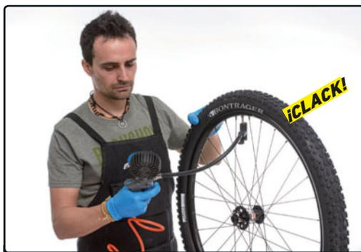
**PASO 8>** Montamos el neumático, aún sin el líquido sellante, y lo hinchamos con el compesor. Ha de talonar bien.
