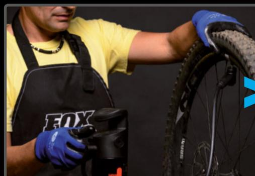
**PASO 9>** ¡Dale gas! La descarga de presión repentina de un compresor debería talonarlo al instante.
