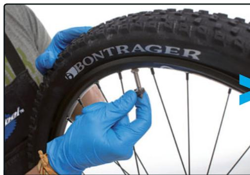
**PASO 9>** Desmontamos el obús, el aire se saldrá, pero el neumático se mantendrá talonado.
