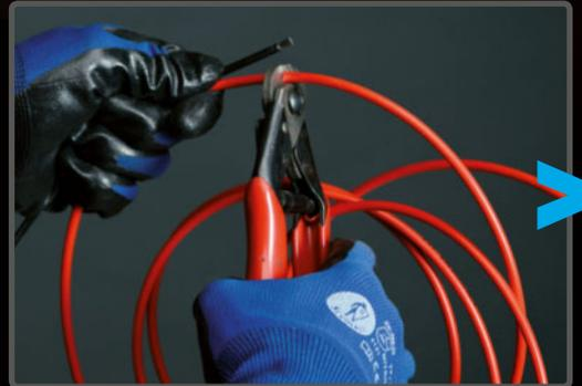
**PASO 3>** Asegúrate bien de que el corte queda totalmente perpendicular a la funda, formando 90°.
