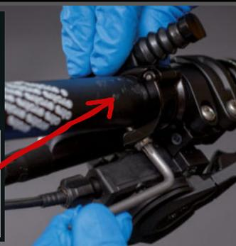
**PASO 10>** Coloca el mando en la posición final para comprobar la longitud del latiguillo.
