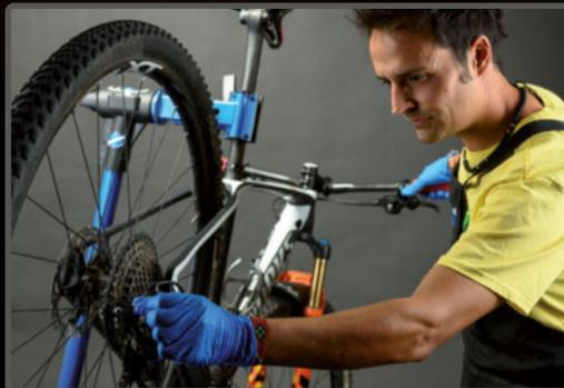
**PASO 2>** Con el cable suelto, realiza algunas pulsaciones para tantear la suciedad del cable: debes notarlo suave.
