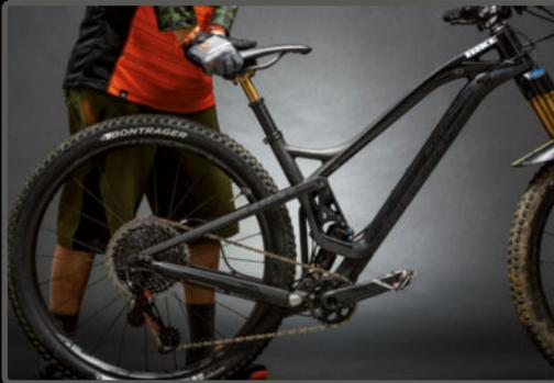
**PASO 5>** Comprueba la longitud de cadena. Si es muy corta podría llegar a partirse en una compresión máxima.
