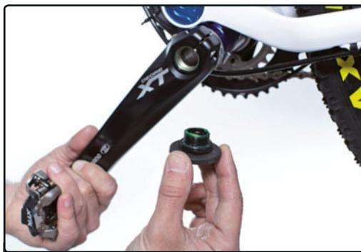
**PASO 2>** Con la herramienta específica de Shimano retiramos la tapa de la biela izquierda.
