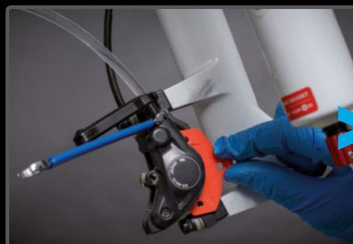
**PASO 9** > El espaciador tiene el ancho del disco. Mantiene las pastillas separadas a la medida justa.
