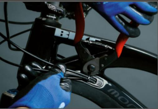
**PASO 1>** Prepara la bici liberando las fijaciones de la funda a sustituir,
