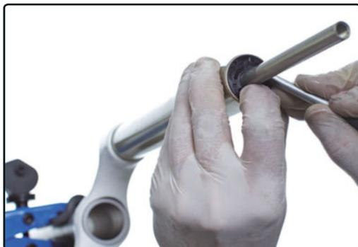
**PASO 10** ➤ Al volver a colocar el circlip asegúrate de que asienta perfectamente en su lugar.
