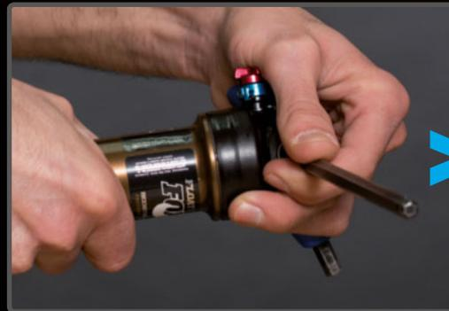
**PASO 3>** La cámara se desenrosca a mano, aunque suele quedarse pegada. Haz palanca con una Allen.
