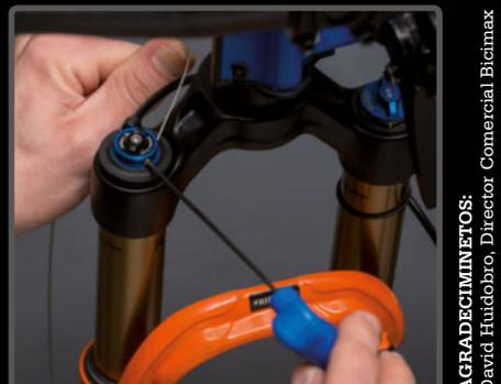
**PASO 12>** Con el mando en posición de "abierto", tensa el cable y fjalo con el tornillo.
