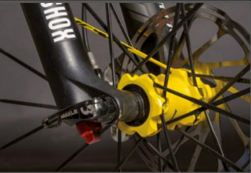
**PASO 1>** RockShox ha diseñado el eje de manera que no interfiera en los diales.
