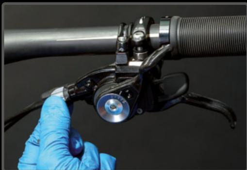
**PASO 4>** Coloca el tensor en un punto medio para tener margen de ajuste en ambos sentidos.
