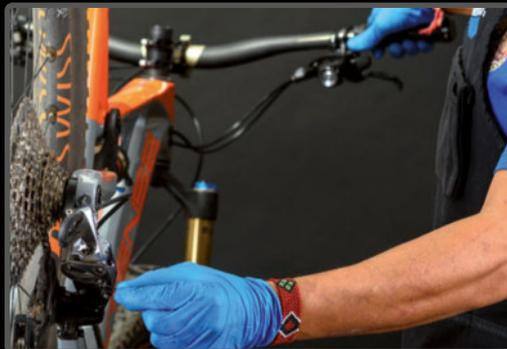
**PASO 2>** Pulsa y contrasta el desplazamiento del cable. ¿Va suave? Perfecto. ¿Parece frenado? Cambia cable y funda.
