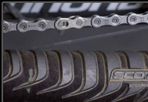
**PASO 10>** La flecha indica el sentido de colocación del eslabón. Un "clack" indica que ha cerrado.
