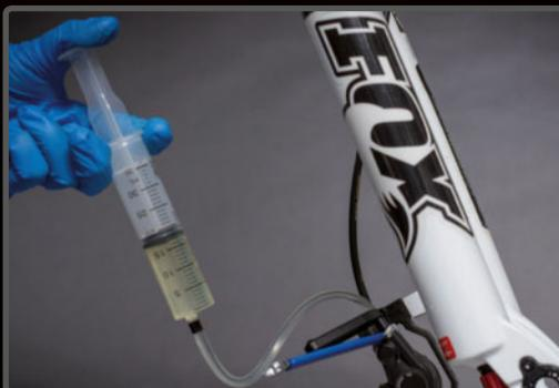
**PASO 5>** El latiguillo está preparado para sujetarse firmemente a la boquilla del purgador, así no se caerá.
