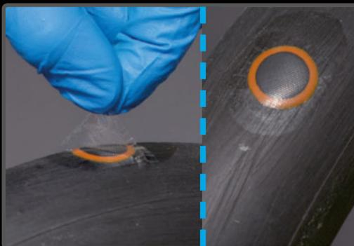
**PASO 11** > La lámina transparente es el indicador del buen pegado del parche. Se debe retirar sin que se levante.
