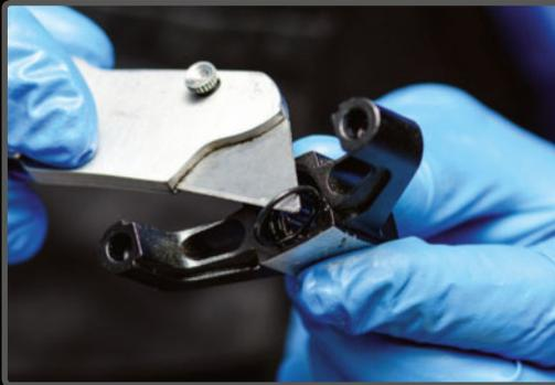
**PASO 5>** Si utilizas un cutter, pon mucho cuidado en no dañar ninguna parte del pedal al extraer las juntas.
