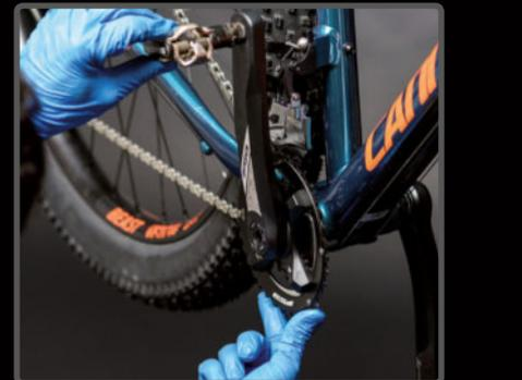
**PASO 12>** Empunta la biela en el estriado a la vez que aprietas el tornillo de fijación.
