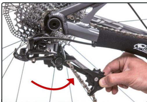
**PASO 2>** En el caso de un cambio SRAM con bloqueo debemos tirar de la caja del cambio hacia la vaina.
