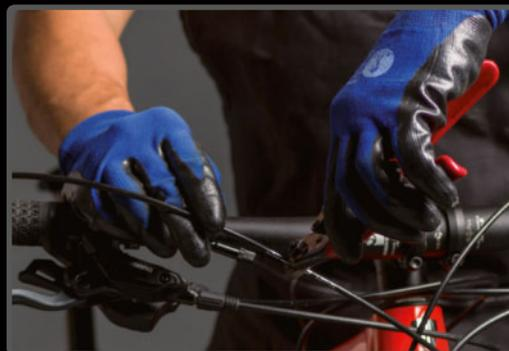
**PASO 8>** Corta la funda a medida, comprobando que dejas margen suficiente para girar a ambos lados.
