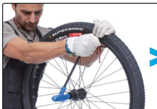
**PASO 9>** Aprieta fuertemente para evitar que el núcleo se pueda aflojar involuntariamente con las vibraciones o con el giro del pedaleo.
