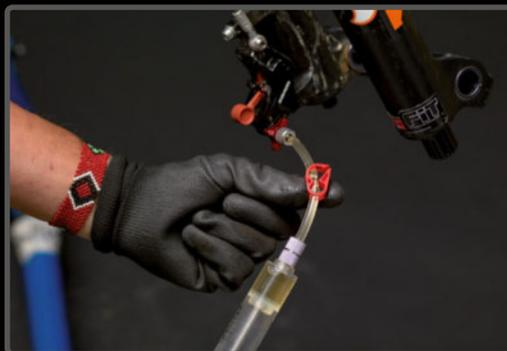
**PASO 8>** ¡No olvides abrir los bloqueos! Solo así podrá fluir el líquido DOT por el interior del circuito.
