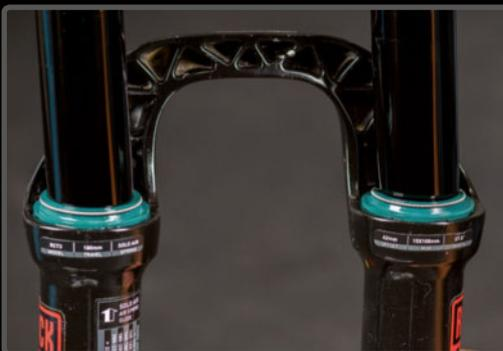
**PASO 11>** Monta las barras de nuevo. Inclínalas un poco te ayudará a meterlas sin doblar el labio del retén.
