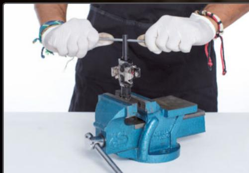
**PASO 2>** Sujeta el eje en el tornillo de banco con cuidado de no dañar la rosca, luego hay que montarlo en la biela.
