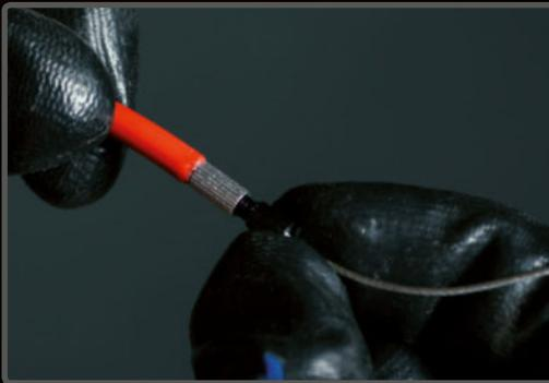
**PASO 5>** Una vez colocado el adaptador necesario, conecta el latiguillo flexible, que lleva un imán en el otro extremo.
