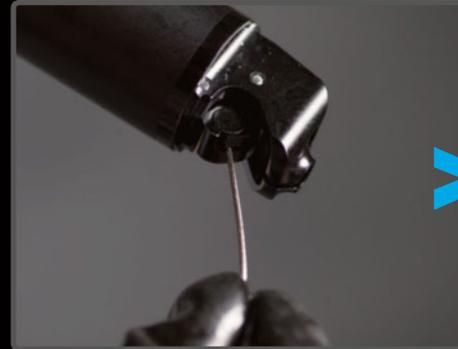
**PASO 6>** Asegúrate que la cabeza del cable encaja correctamente en su posición.
