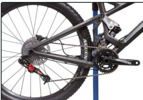
**PASO 11** ➤ Comprueba la longitud de la cadena. Comprime la suspensión a tope para simular el estiramiento.
