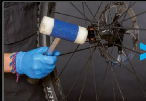
**PASO 3>** El rodamiento adquirirá holgura por los golpes sobre la pista interna, y habrá que cambiarlo.
