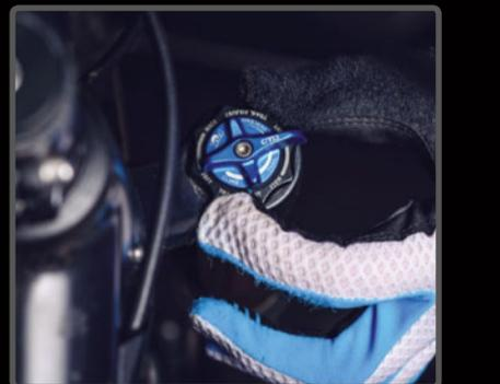
**PASO 12** ➤ Algunas horquillas Fox tienen "ajuste fino" en la posición de pedaleo.
