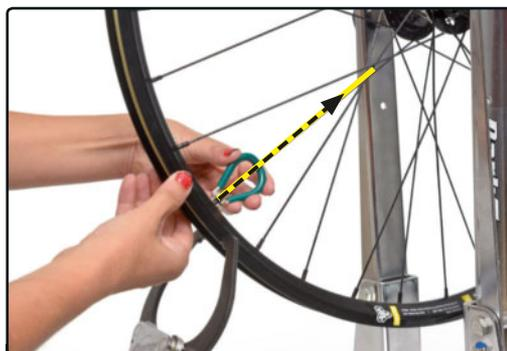
**PASO 8>** Si roza en el lado derecho, tensa el radio del lado contrario para "llevar" la llanta hacia a la izquierda.
