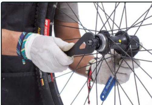
**PASO 11>** Para realizar los primeros ajustes sujeta el eje por el lado del núcleo. Para ello es probable que necesites un segundo juego de llaves.
