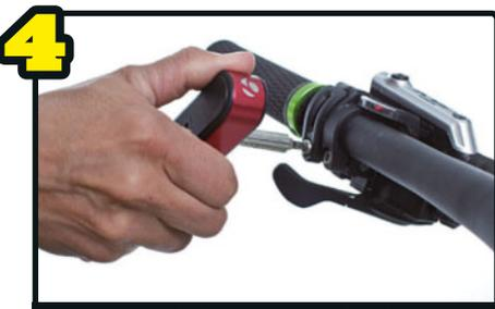
**4** Las manetas de freno y de cambio de Shimano se aprietan al mismo par, entre 3 y 5 Nm. La dinamométrica prefijada nos servirá.
