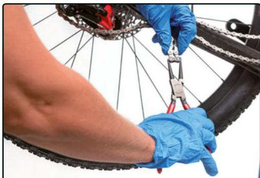
**PASO 4** ➤ Desmonta la cadena usada. Un alicate te ayudará a abrir el eslabón desmontable.
