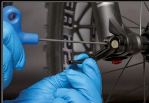
**PASO 8>** Antes de cerrar la palanca, ajusta la tensión del expansor que, internamente, ajusta el eje a la puntera.
