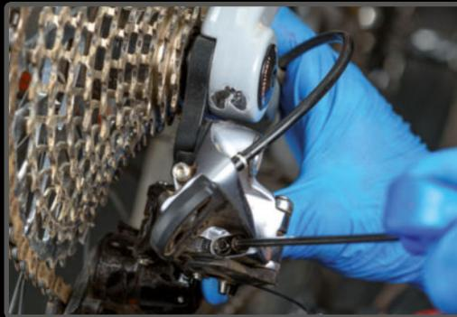
**PASO 5>** Aprieta ligeramente el cambio para asegurarte de que la cadena no se va a caer hacia los radios.
