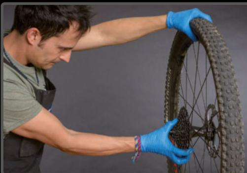
**PASO 11 >** Truco: en algunas ruedas no hace falta desmontar todo el buje para acceder al núcleo.
