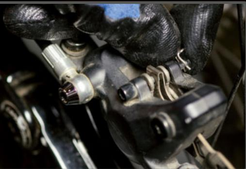
**PASO 1>** El clip de seguridad afianza todo. No lo pierdas para montarlo después.
