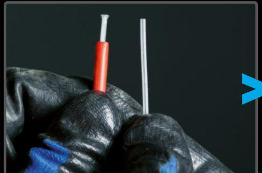
**PASO 9>** Para que el tubo de Teflon quede bien fijado, debes colocar el borde en el extremo superior.
