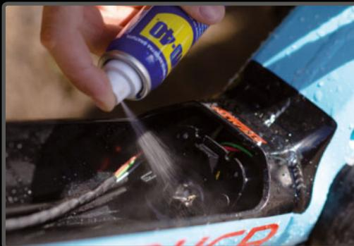
**PASO 11>** Inspecciona y seca los contactos, también el puerto de carga. El WD40 crea una capa protectora.
