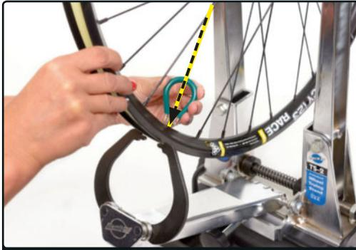
**PASO 5** > Separa la llanta del buje liberando tensión de los radios afectados (gira la cabecilla en sentido anti horario).
