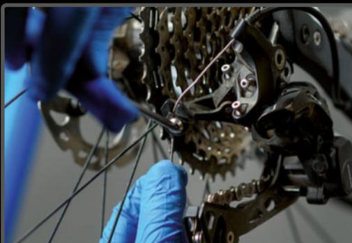
**PASO 10>** ¿Recuerdas la posición del cable en el prisionero del paso 1? Pues tensa y fíjalo ahí.
