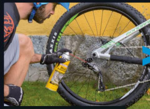
**PASO 3** > Utilizando un jabón formulado para bicis, lo pulverizamos sobre el cuadro y demás partes de la bici. Lo dejamos actuar unos minutos.
