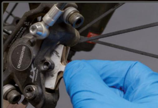
**PASO 2>** Una vez extraigas las pastillas aprovecha a limpiar el hueco con agua y jabón, ya que estará cubierto de suciedad proveniente del desgaste de las pastillas.
