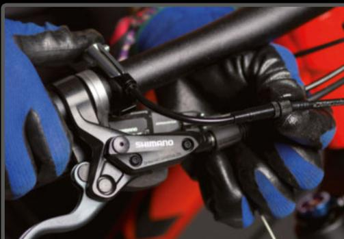
**PASO 11>** El ajuste fino de la tensión del cable es crucial para que la tija suba y baje a la velocidad correcta.
