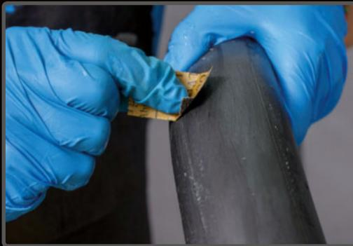
**PASO 5** > Si no lijas correctamente, en diferentes direcciones, el pegamento no pegará como es debido.
