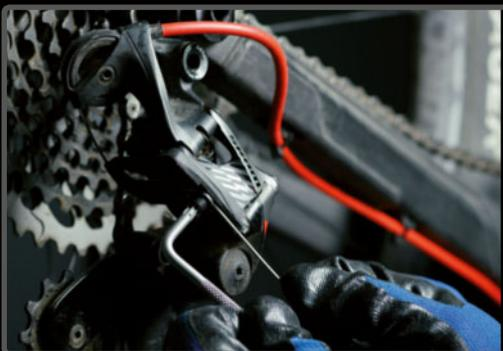
**PASO 11>** Los cambios SRAM requieren un enrevesado guiado de cable, pero fundamental para un buen resultado.
