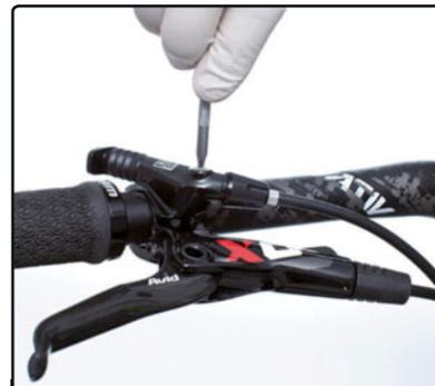
**PASO 12>** Aprieta el tornillo con una llave dinamométrica a 1,7 Nm. Si no tienes, utiliza una llave pequeña con poca palanca.
