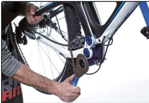
**PASO 5>** Recuerda que para extraer el eje de pedalier la rosca del lado izquierdo va al revés.
