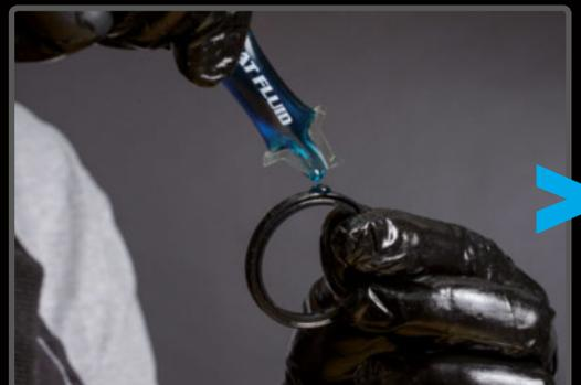
**PASO 9>** Lubrícate los dedos y recorre todo el retén para que quede completamente lubricado.
