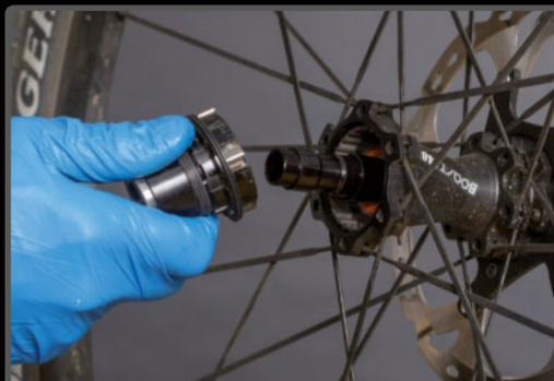
**PASO 8>** Antes de abrir el núcleo en la rueda trasera es necesario desmontar el casete, en la mayoría de ruedas.
