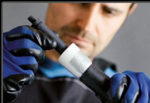
**PASO 8>** Para fijar la batería dentro de la tija hemos utilizado un trozo de espuma del propio embalaje de la bici.
