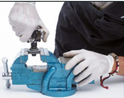
**PASO 1>** Si no tienes tornillo de banco necesitarás una llave fija de 36 mm para manipular el extractor.
