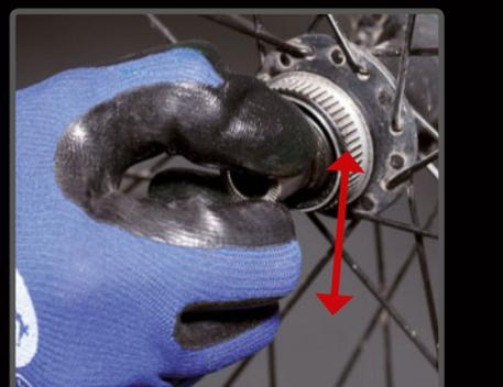
**PASO 12>** Comprueba la ausencia de holgura forzando el eje hacia arriba y abajo.
