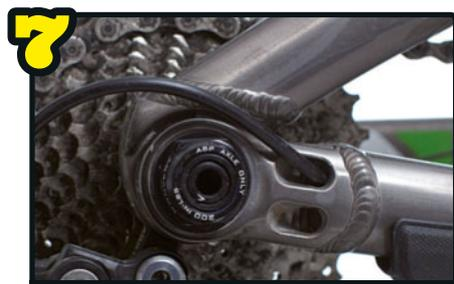
**7** Cada pivote lleva su par de apriete particular, en función de los materiales y de las fuerzas a las que está sometido. Varían de un fabricante de bici a otro.
