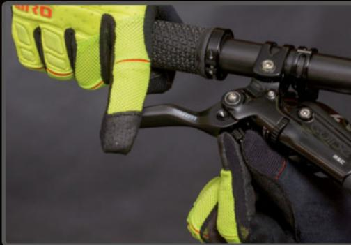
**PASO 5>** Con el tornillo o el regulador manual (en estos SRAM) ajustamos la separación de la palanca al manillar.
