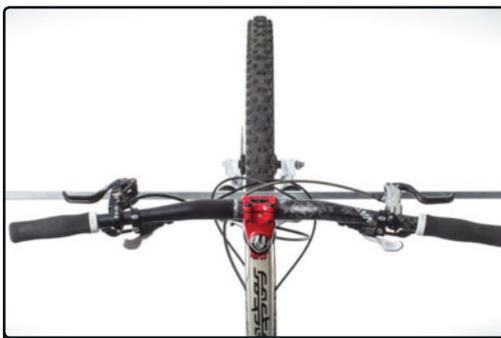
**PASO 11>** ¡Asegúrate de que la barra que utilizas está totalmente recta! Hay algunos trucos para dejar la dirección completamente alineada. No hay nada peor que una dirección desalineada.
