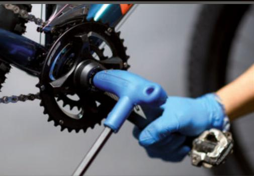
**PASO 1>** FSA se desmonta por la derecha. Shimano o SRAM por la izquierda.
