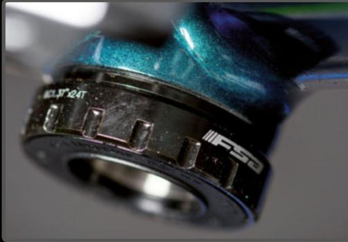
**PASO 5>** El pedalier es compatible con desviadores de placa de fijación al pedalier. El separador ocupa ese lugar.
