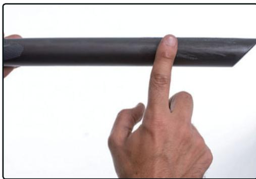
**PASO 4>** Reparte la pasta de montaje en la superficie de la tija en contacto con el cuadro.
