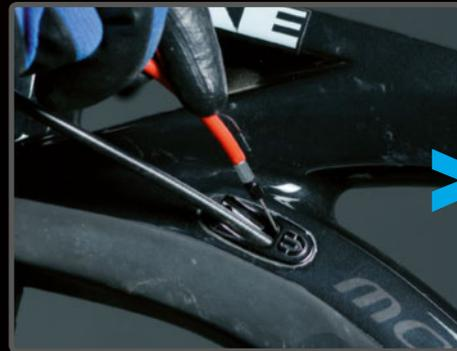
**PASO 6>** Empieza por la parte superior para que la gravedad nos facilite el proceso.
