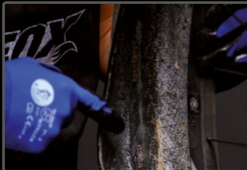
**PASO 2>** Si no utilizas la bici durante un tiempo el líquido puede aglutinarse y secarse en el punto más bajo.
