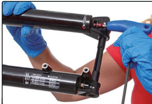
**PASO 2>** Suelta los tornillos hasta la mitad. Unos cuatro hilos de rosca serán suficiente.
