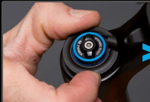
**PASO 9>** Gira la base para dar tensión al muelle. La base tiene muescas donde la puedes ir fijando.
