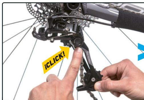
**PASO 3>** Presionamos el pulsador del bloqueo y soltamos la caja de cambio.
