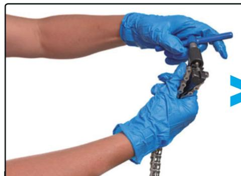
**PASO 6** ➤ Corta la cadena a la medida que necesita tu bici usando el tronchacadenas.
