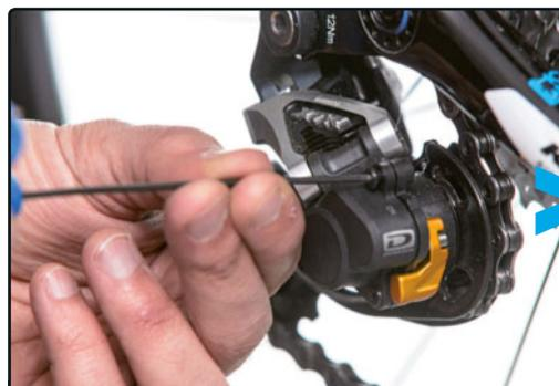
**PASO 9>** Para ajustar la tensión del bloqueo hemos de sacar tres tornillos Allen de 2 mm.
