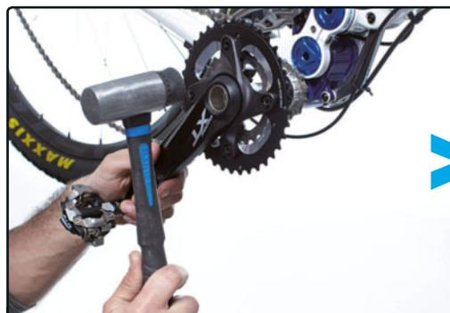
**PASO 9>** Ayúdate de una maza con cabeza de nylon/goma para montar de nuevo la biela derecha.
