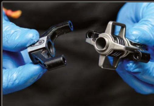
**PASO 4>** El bloque del resorte de 4 caras se mantiene en una pieza, no es desmontable.
