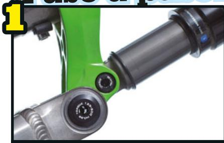
**1** Los anclajes del amortiguador tienen que ser apretados con un determinado par para no "estrangular" el libre giro. Dependerá de cada fabricante.
