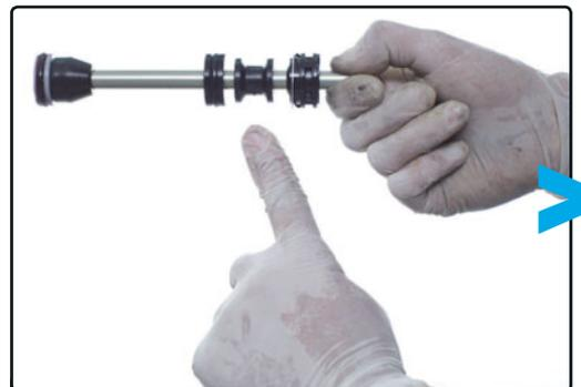
**PASO 9>** Aquí puedes ver el espaciador ya colocado en su posición, en este caso el de 20 mm.
