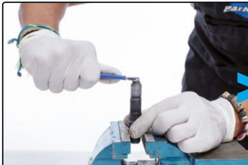
**PASO 3>** Sujeta el eje al tornillo de banco directamente. Si no tienes, utiliza una llave fija de 15 mm para sujetar el eje mientras aflojas la tuerca superior.
