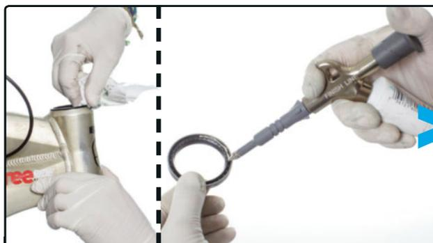
**PASO 3>** Con la hoja de un cúter puedes levantar el retén del rodamiento, con cuidado de no cortarlo, para poder engrasar las bolas como se aprecia en la imagen.
