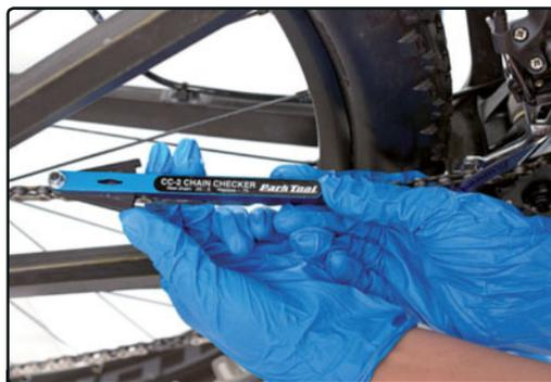
**PASO 2** > Si se ha estirado más de 0.75% cámbiala para conservar el buen estado del resto de la transmisión.
