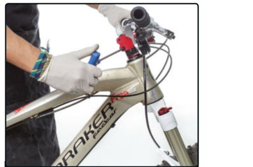
**PASO 12>** Antes de ajustar la holgura hay que reinstalar el freno delantero, ya que se necesita frenar para comprobar el juego de la dirección.
