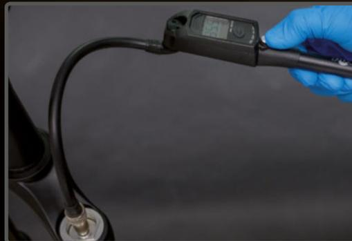
**PASO 2>** Antes de vaciar el aire, anota la presión original, para comprobar los cambios que vamos a realizar.
