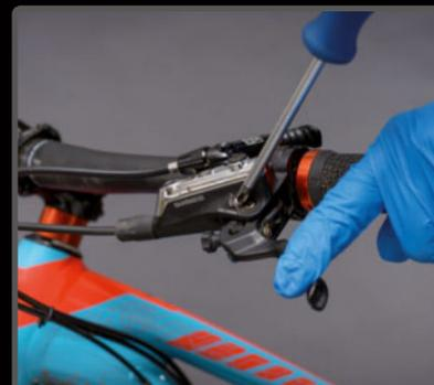
**PASO 12>** Algunos frenos permiten personalizar el tacto de frenada para simular una acción más o menos tensa.
