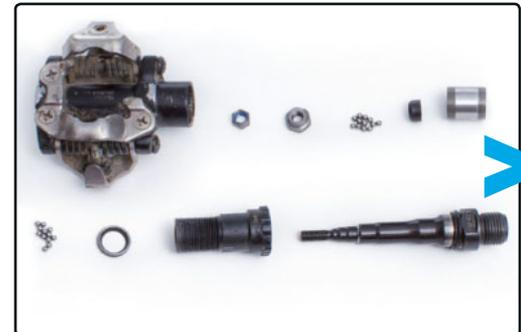
**PASO 6>** Con el eje desmontado, revisa el estado de todos los elementos en busca de desgastes u otras anomalías.
