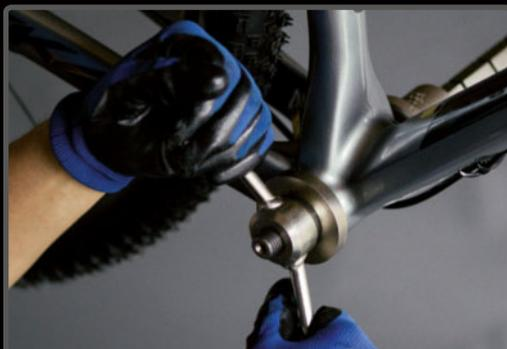
**PASO 10>** Al introducir el pedalier, asegúrate de que no interfiere con los cables E-Tube.
