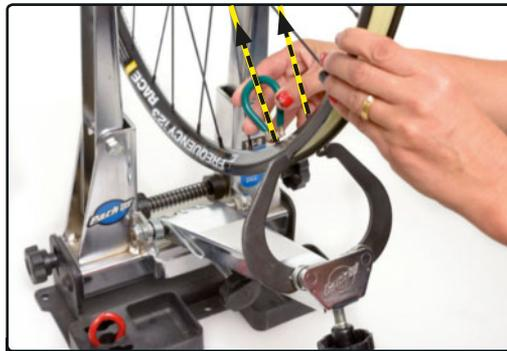
**PASO 2>** Acerca la llanta al buje apretando (sentido horario en la posición de la foto) el radio próximo al roce.
