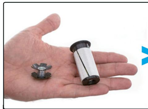
**PASO 6>** Si el tubo de tu horquilla es de carbono necesitarás una araña específica.
