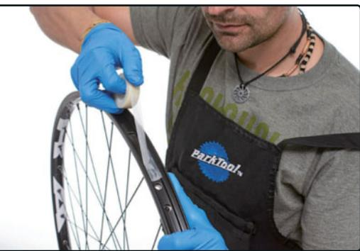
**PASO 1>** Colocamos la cinta adhesiva que tapará la cabeza de los radios.
