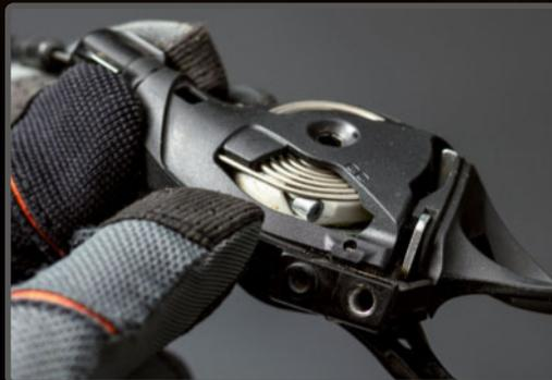
**PASO 2>** Levanta el muelle en espiral y asegúrate de dejar encajada la cabeza del cable en su lugar correspondiente.
