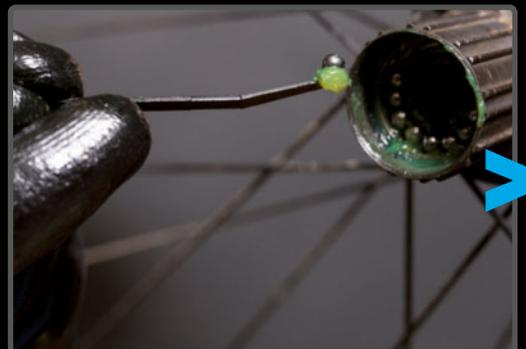
**PASO 9>** ¡Truco! Una gota de grasa en la punta de una brida facilita la reintroducción de las bolas.
