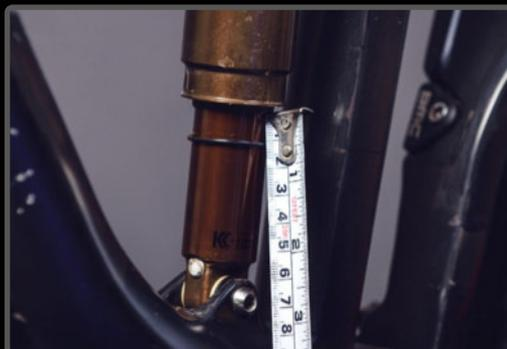
**PASO 8>** En el amortiguador el sag se calcula sobre el recorrido del amortiguador, no sobre el real de la rueda.
