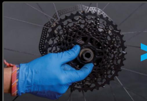
**PASO 9>** Atención a las pestañas-guías del núcleo: las coronas sólo entran en una posición determinada.
