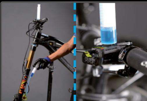
**PASO 10** > Inyectando aceite desde la parte inferior empujamos las burbujas de aire hacia arriba.
