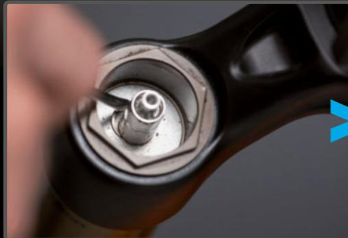
**PASO 3>** Empuja con dos destornilladores sobre las puntas del circlip para empujarlo fuera y sacarlo.
