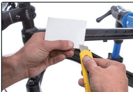
**PASO 10>** Utiliza protectores adhesivos en las partes del cuadro en contacto con cables
