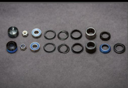
**PASO 7** > El nuevo kit (abajo) ofrece un mejor sellado del rodamiento junto a la biela.
