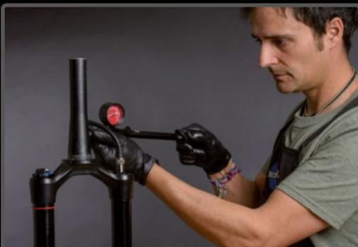
**PASO 10>** Utiliza una bomba de alta presión para manipular las suspensiones de tu bici.
