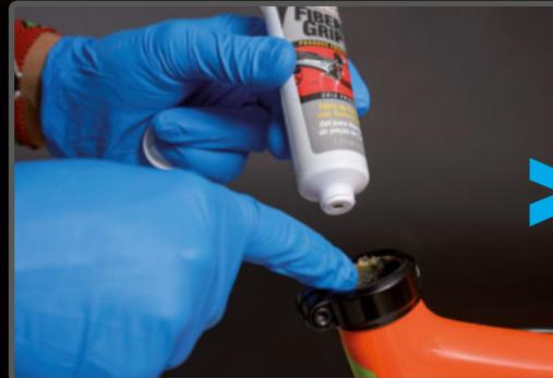
**PASO 3>** La pasta de montaje tiene partículas que crean una gran fricción, evitando el deslizamiento.
