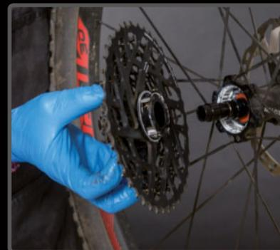
**PASO 12 >** Tirando del casete, el núcleo sale y podemos hacer el mantenimiento fácilmente.
