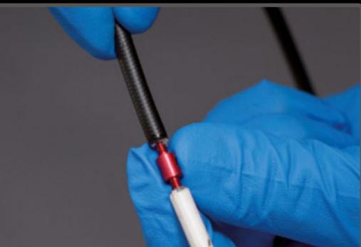
**PASO 7>** La doble rosca del terminal de empalme facilita introducir el latiguillo.
