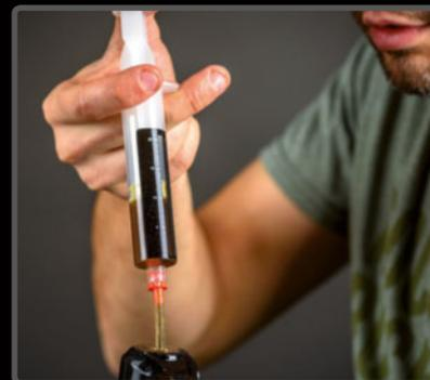
**PASO 12>** Introduce el aceite y vuelve a montar los tornillos inferiores de la horquilla.
