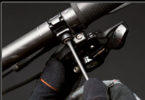
**PASO 11>** Sin cambiar la posición de la maneta de freno, también puedes ajustar la altura del mando.
