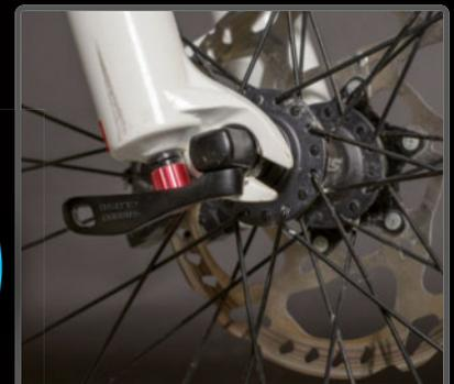
**PASO 12** > Que la palanca no interfiera con otros elementos como los diales o el disco.
