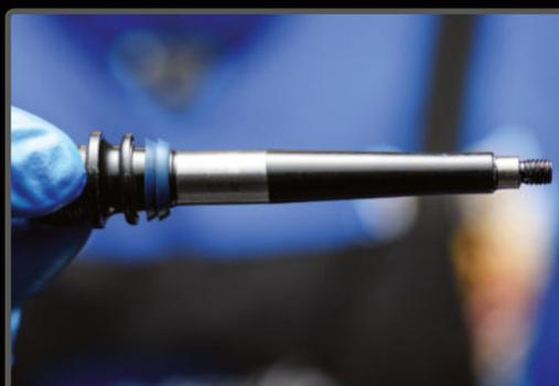
**PASO 8** > Revisa el eje. Comprueba que no estén desgastadas las zonas pulidas, donde apoyan los rodamientos.
