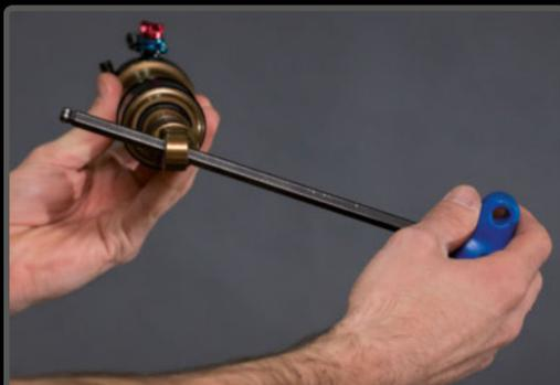
**PASO 10>** Si no alineas correctamente los ojos del amortiguador, no podrás reinstalarlo en la bici.
