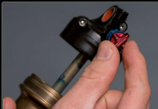
**PASO 8>** Cierra el rebote y comprime el amortiguador para mantenerlo comprimido y facilitar el paso 9.
