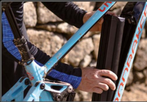
**PASO 4>** La batería siempre hay que apagarla y después desmontarla. Así no habrá corriente.
