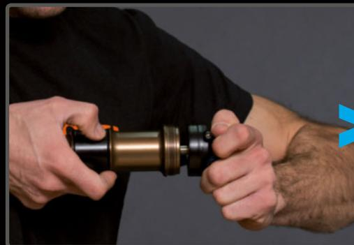
**PASO 9>** Introduce la cámara. La resistencia que aprecias es la cámara negativa, que se ha precargado.
