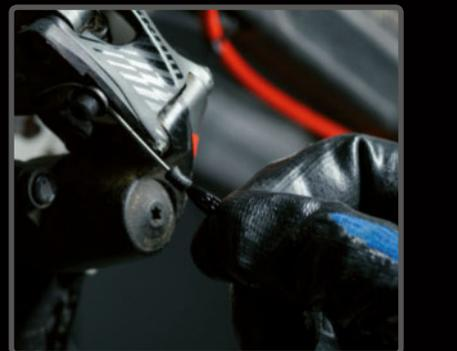
**PASO 12>** El terminal de cable da un acabado final "fino" y evita que nos pinchemos.
