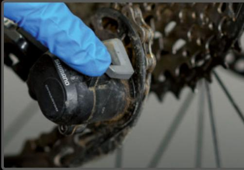
**PASO 5>** El tensor del muelle de la caja de poleas debe estar desactivado o al mínimo, para que no interfiera.
