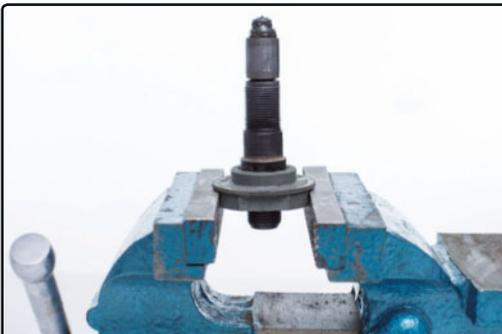
**PASO 2>** El eje al desnudo. Antes de comenzar a desmontar el eje, limpia la grasa sucia externamente, para poder manipular con más pulcritud.
