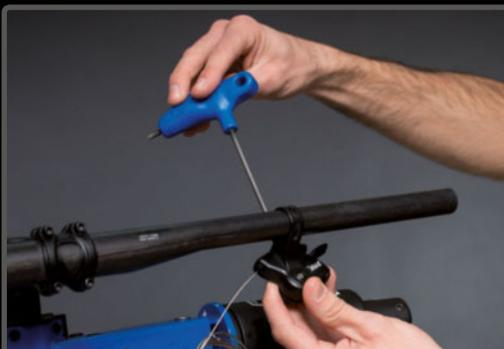
**PASO 11>** Este mando de Fox requiere desmontar el puño y manetas para introducirlo en el manillar.
