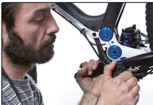
**PASO 10>** Monta la biela izquierda y rosca la tapa a mano con la herramienta de Shimano.
