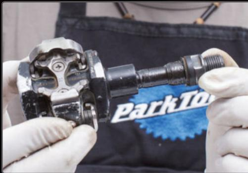
**PASO 5** > Extrae el eje del cuerpo del pedal con mucho cuidado para no perder ninguna bola en el proceso.
